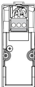
Выдавить отверстие для прокладки кабелей. При проводах диаметром > 11 мм боковая крышка должна быть выпилена большего размера.
