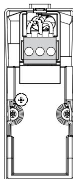
Kabelführungsöffnung ausbrechen. Bei Leitungsdurchmesser >11 mm muss die Seitenkappe entsprechend größer ausgesägt werden. Nach dem Anschluss Seitenkappe wieder aufstecken und festschrauben.
